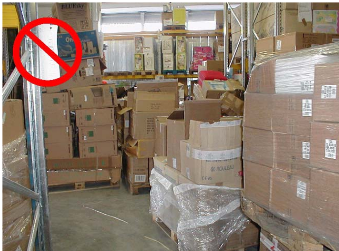
Vie di transito ingombre di merce
