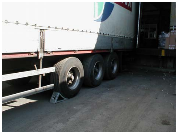
Bloccaggio delle ruote con cunei
