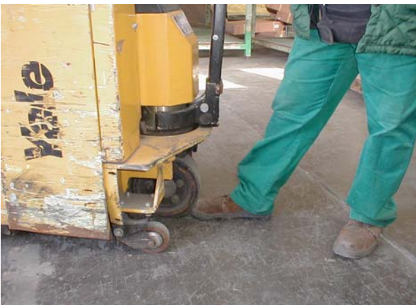
Carrello privo di protezione pr evitare lo schiacciamento dei piedi
