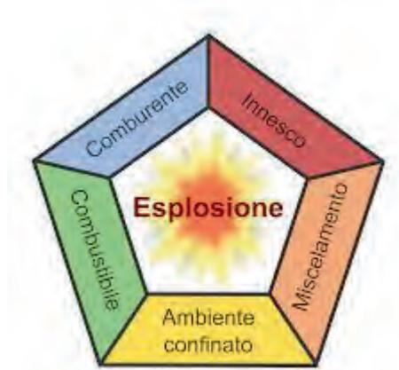
Figura 26: Il “pentagono” dell'esplosione
