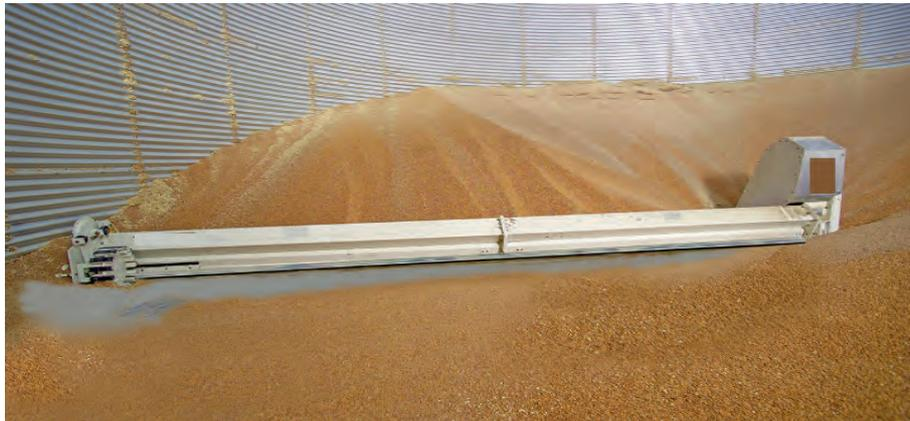
Figura 27: Coclea raccoglitrice (fonte Contarp Inail)
